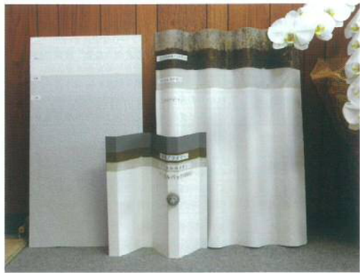
ケミカルカチオンパックの三層構造。中間層が断熱のポイント
